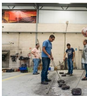
Figura 7 Rolamento de Chocalhos (Man. Chocalhos_Fábrica_10)
