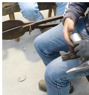
Figura 10 Vergar a chapa (Man. Chocalhos_Fábrica_27)
