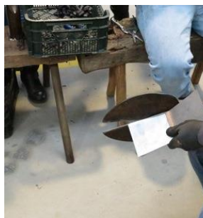
Figura 9 Cortar a chapa (Man. Chocalhos_Fábrica_26)
