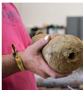
Figura 29 Chocalho «embarrado» (Man. Chocalhos_Fábrica_36)
