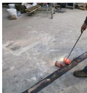
Figura 14 Arrefecimento de Chocalhos (Man. Chocalhos_Fábrica_31)
