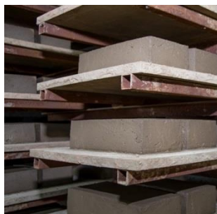
Figura 25 Secagem do barro (Construção Tradicional_Secagem_S.Pedro Corval_2)
