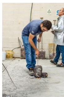
Figura 6 Processo de rolar os Chocalhos (Man. Chocalhos_Fábrica_9)
